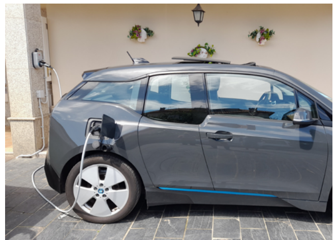
/ Wattpilot Home ubicado en el porche de la vivienda cargando uno de los dos coches eléctricos
